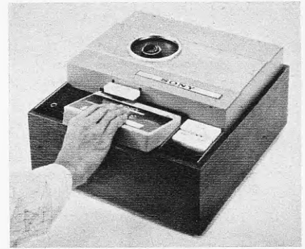
Bild 1. Die Sony-Videokassette läßt sich mit einer Hand einlegen; für die Bedienung des zugehörigen Videoplayers sind lediglich vier Tasten vorgesehen
