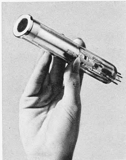
Bild 1. Extrem lichtempfindliche 1-Zoll-Bildaufnahmerröhre mit mehreren hunderttausend Fotodioden als Target (Modell C 23136 von RCA)
